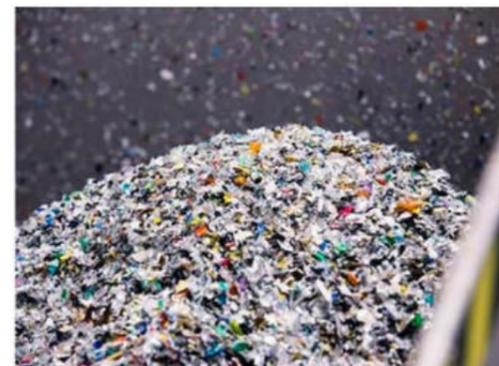
Grâce à divers processus de séparation et de nettoyage, un regranulat est finalement créé à partir de ces déchets recyclés et traités.
